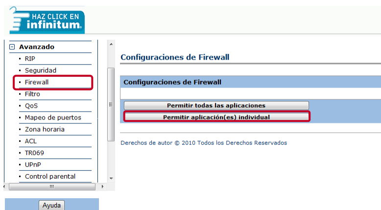
Figura 4.1-4. Configuración de Firewall en Modem.
